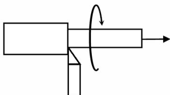
3. Из цилиндрической заготовки радиуса  $R$ , длиной  $h$  токарь резцом на токарном станке вырезает цилиндр радиуса  $3R/4$ , снимая металл резцом за один проход (см. рисунок). На какое максимальное расстояние смещается центр тяжести заготовки в процессе ее обработки?
